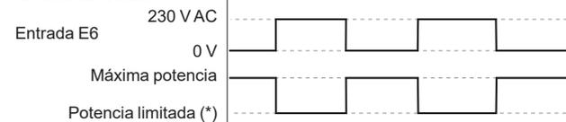
(\*) Limitación de corriente definida durante la configuración de la estación de carga Inicio diferido
